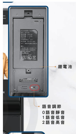
室內機電池倉：鋰電池＋語音調節撥鈕
