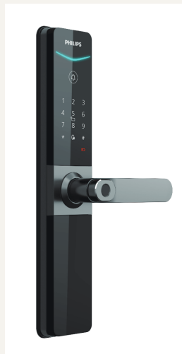
外面板：觸控數字鍵盤＋門鈴＋卡片識別區，指紋辨識整合於把手軸心
